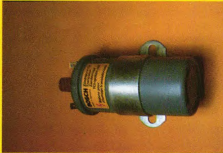
Afb. 14. Deze bobine van Bosch geeft de beste resultaten. De bobine is bedoeld voor 12 V gebruik in samenwerking met de speciale voorschakelweerstand.
